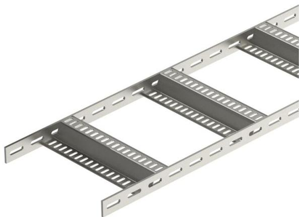
Bandeja de escalera para barcos ligera, con barra lateral perforada de ala 40 mm con peldaños en forma de Z soldados y perforados. Carga probada según CEI en combinación con conector SLV.
