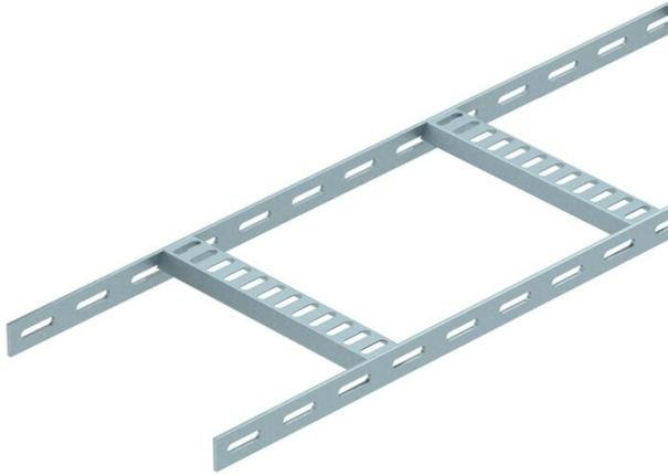
Bandeja de escalera para barcos con barra lateral perforada de ala 25 mm con peldaños trapecoidales, soldados, perforados y abiertos hacia abajo. Carga probada según CEI en combinación con conector SLV.
