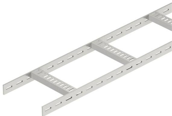
Bandeja de escalera para barcos con barra lateral perforada de ala 40 mm con peldaños trapecoidales, soldados, perforados y abiertos hacia abajo. Carga probada según CEI en combinación con conector SLV.
