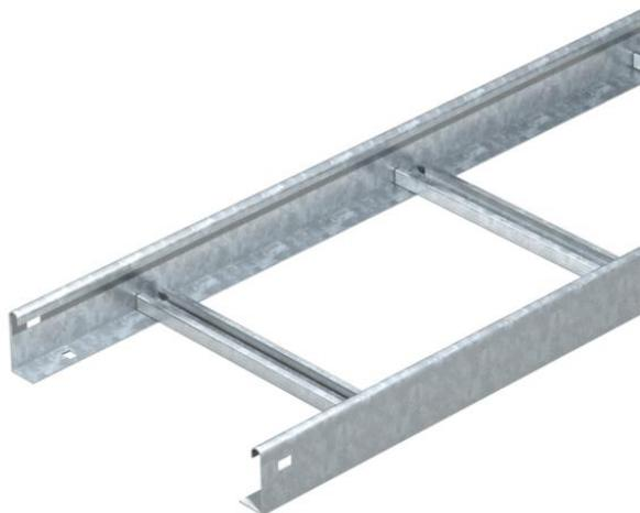
Bandeja de escalera para el tendido horizontal de cables y líneas. Se puede utilizar como estructura de soporte estándar para el mantenimiento de función según DIN 4102 parte 12. Clases de mantenimiento de función de E30 a E90. Con remache de perfil en C remachado abierto en la parte superior.
