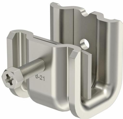
Este tipo de abrazadera de sujeción se desliza sobre el soporte y se fija al mismo, o al acero plano, mediante una cubeta de presión y un tornillo (M8). El tornillo de cabeza hexagonal tiene un ancho de llave de 10 mm. En el cuerpo de abrazadera se instalan además otras dos roscas M6 para fijar por ejemplo varillas roscadas.
