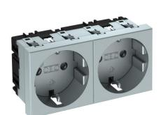
Toma de corriente con clavija de puesta a tierra doble  $0^\circ$ , con protección aumentada contra contacto accidental, con bornes de enchufe, de 2 polos, 16 A, 250 V~, con bornes de conexión según IEC 60884-1.
