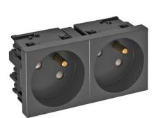
Toma de corriente con clavija de puesta a tierra con conexión lateral doble, 33°, con protección elevada contra rozamiento, con bornes de enchufes, de 2 polos, 16 A 250 V~, con bornes de unión según IEC 60884-1.
