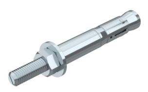
El taco para fijación pesada SZ es un sistema de anclaje de paso de alto rendimiento con casquillo especial de expansión triple que permite cargas elevadas en distancias pequeñas de ejes y bordes.
