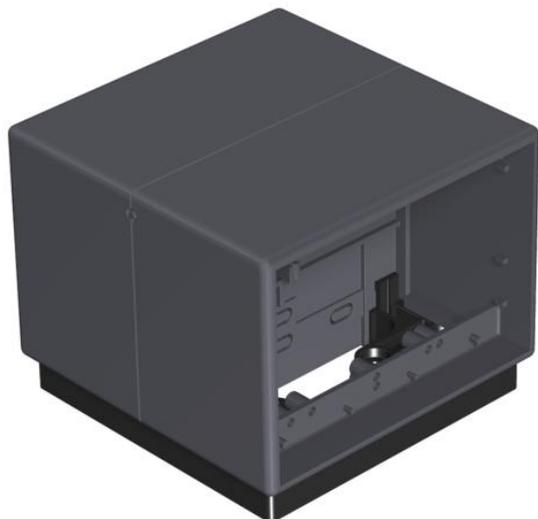
Para el montaje combinado de 4 mecanismos individuales con estribo de soporte (4 mecanismos de un tipo de corriente o dos grupos de 2 mecanismos con dos tipos de corriente). Las tomas con diferentes tipos de corriente se aíslan mediante una pared separadora. Con tornillos para el montaje de mecanismos con soporte de fijación: 60 mm, en vertical.
