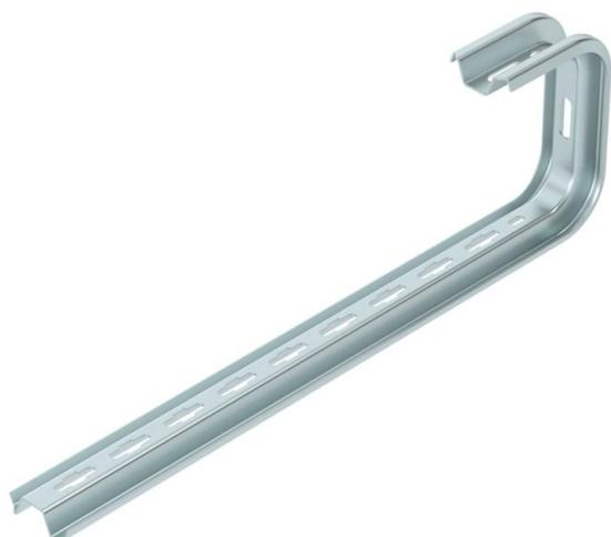
Escuadra de pared/techo TP para la fijación universal de construcciones. Importante. Si el soporte se fija directamente a la pared o al techo, por razones de estabilidad, se instala siempre una pieza distanciadora DS 4. Altura lateral máx. del sistemas de bandejas portacables de 60 mm.
