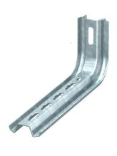
Escuadra para el montaje en los perfiles colgantes TPS o como escuadra de pared para la bandeja portacables con mantenimiento de función según la DIN 4102, parte 12.
