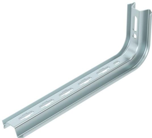
Perfil TP para la utilización como un perfil para cargas ligeras en paredes de hormigón horizontales, en una longitud de 145 - 645 mm. Hasta una longitud de 345 mm, el perfil se instala como un escuadra para cargas ligeras.
