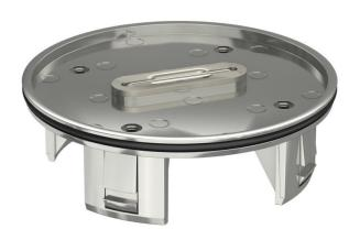
Salida de cables de altura regulable para el montaje en tapas y marcos RKF así como en tapas y marcos redondos y cuadrados de altura regulable RKFR y RKFN. Mientras se está utilizando sobresale por encima del suelo y si no se utiliza, permanece a ras del suelo. Aplicación en pavimentos que precisan una limpieza con agua. Con rebaje de pavimento de 4 mm para revestimiento a cargo del propietario con pavimento a prueba de cortes, con asa.
