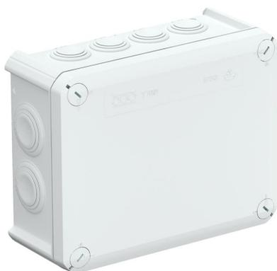
Caja de derivación para la conexión de cables y líneas en zonas interiores y zonas exteriores protegidas. Forma rectangular con juntas insertables en los lados y entradas ciegas en el suelo. Apropiado para el montaje en pared y techo, y el montaje en estructuras de chapa. Con la posibilidad de fijación interior y montaje mediante cúpulas esquineras. Tapa con cierre rápido, precintable. Modelo antiinflamable de polipropileno especial.
