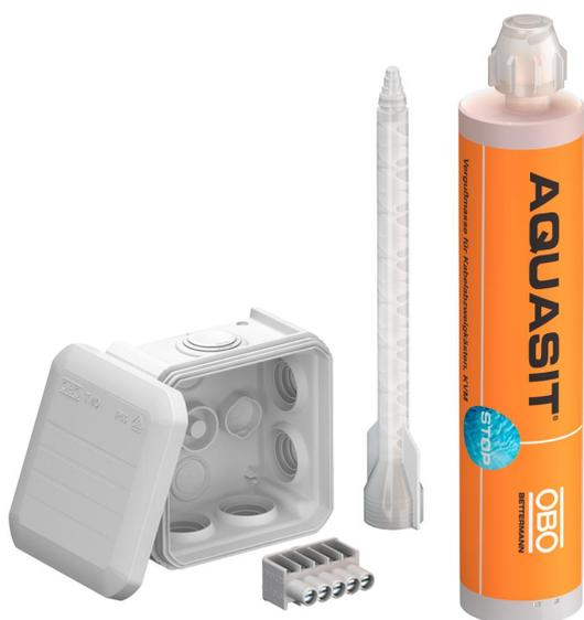
Juego de cajas de derivación con regleta de bornes para conectar cables y conductos en interiores y exteriores protegidos. Incluido gel de sellado en frío Aquasit, grado de protección IP 68. Forma cuadrada con juntas insertables en los lados y entradas ciegas en el suelo. Apropiado para el montaje en pared y techo, y el montaje en estructuras de chapa. Con la posibilidad de fijación interior. Con tapa de bornes fija. Fabricado con materiales sin halógenos.
