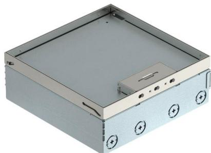
Caja de suelo cuadrada para el montaje en suelos huecos y en pavimentos que precisan una limpieza en seco. La carcasa empotrable dispone de entradas pre-troqueladas para tubo (M25). Se puede ajustar la altura hasta el borde superior del revestimiento del suelo mediante los 4 soportes niveladores. La profundidad mínima de montaje es de 95 mm y el margen de nivelación de + 30 mm.
