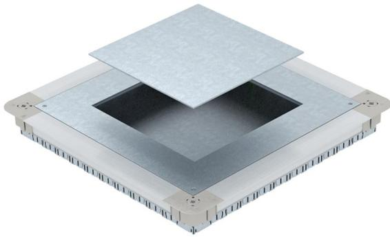
Caja portamecanismos con tapa de montaje y placa ciega con paredes laterales de chapa de acero. Para el montaje de una caja portamecanismos cuadrada GES9 55 en pavimentos a partir de 55 mm de altura. Se puede nivelar de forma continua a la altura de pavimento y el pavimento puede montarse a ras del borde de extracción del pavimento. Con aberturas para introducción de tubos en cada lado 7 x M20, 3 x M25, 4 x M32. Tamaño útil de tubo con una altura de sistema de 55 mm: M20.
