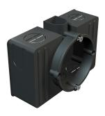
Caja portamecanismos/de conexiones con volumen de caja ampliado por ambos lados del hueco de instalación del mecanismo para el alojamiento de los bornes de conexión. Protección contra el retorcimiento, distancia de combinación normalizada y garantizada de 71 mm (según DIN 49 073-1) mediante acoplamiento de encaje rápido. Aberturas rompibles para conductos y tubos de hasta Ø 21 mm, soportes profundos para empotrado,
