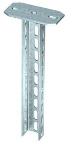
Soporte colgante (perfil en U) de medidas 70 x 50 mm con cabeza soldada. Para fijación en techos de hormigón y vigas metálicas horizontales. Con escuadras a partir de 400 mm de ancho o en caso de que la escuadra se instale en el extremo del perfil colgante, se recomienda utilizar la pieza distanciadora DSK 61.
