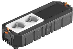
El soporte universal UTC4 listo para conectar tiene dos tomas de corriente con toma de tierra 33° preinstaladas con 16 A y dos tapas ciegas para el montaje posterior de dos mecanismos de la serie Modul 45 o Modul 45connect. Adecuado para los cables de conexión VL y para su uso en las cajas portamecanismos del tamaño nominal R7, R9 y 9.
