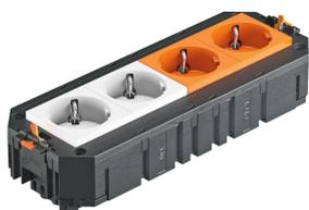
El soporte universal UTC4 listo para conectar tiene dos tomas de corriente con toma de tierra 33° preinstaladas en blanco puro y dos tomas de corriente con toma de tierra 33° preinstaladas en naranja puro con 16 A. Adecuado para los cables de conexión VL y para su uso en las cajas portamecanismos del tamaño nominal R7, R9 y 9.
