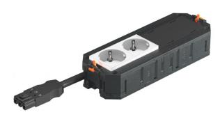
El soporte universal UTC4 listo para conectar tiene 2 tomas de corriente con toma de tierra 33º preinstaladas en blanco y 2 tapas ciegas para el montaje posterior de 2 mecanismos de la Modul45. Adecuado para los cables de conexión VL y para su uso en las cajas portamecanismos del tamaño nominal R7, R9 y 9.
