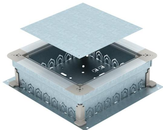
Caja de derivación y de registro para cada 7 tubos de instalación por lado (M20 o M32) con paredes laterales de chapa de acero. Para el montaje de unidades en tapa de montaje (pedir por separado). Se puede nivelar de forma continua a la altura de pavimento (es posible una nivelación rápida) y el pavimento puede montarse a ras del borde de extracción. Con posibilidad de desacoplamiento acústico tras el montaje de pavimento y de aplicación de cargas pesadas con accesorios adicionales.
