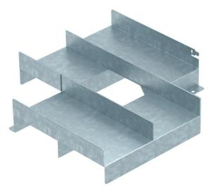
Elemento separador de 3 compartimentos para cruce en una caja bajo suelo UZD250-3 o UGD250-3, para canales de derivación con ancho de 250 mm.
