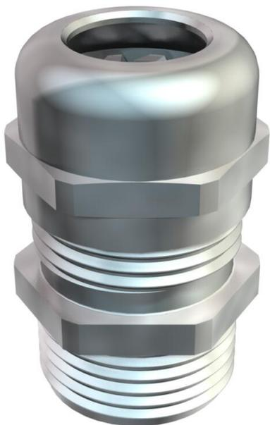
Prensaestopas tipo tuerca de capuchón con amplia zona estanca, así como con descarga de tracción y protección contra la torsión para situaciones donde se exija una alta estanquidad con rosca de conexión PG larga según DIN 40430, con paredes de envolvente gruesas se debe utilizar una contratuerca para la conexión.
