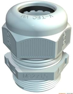
Prensaestopas con rosca de conexión métrica de tipo con tuerca de capuchón, para cajas de derivación, carcasa, armarios de distribución en sector privado e industrial. Con descarga de tracción y labio de sellado integrado , probado según DIN EN 62444. Clase de protección IP68. Se puede utilizar entre -20 °C y +65 °C.
