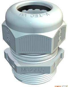
Prensaestopas con rosca de conexión métrica de tipo con tuerca de capuchón, para cajas de derivación, carcasa, armarios de distribución en sector privado e industrial. Con descarga de tracción y labio de sellado integrado , probado según DIN EN 62444. Clase de protección IP68. Se puede utilizar entre -20 °C y
