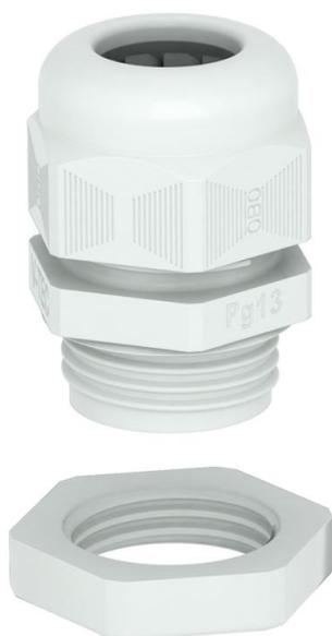
Prensaestopas con rosca de conexión métrica PG de tipo con tuerca de capuchón, para cajas de derivación, carcasa, cajas de distribución en sector privado e industrial. Con descarga de tracción y labio de sellado integrado, probado según DIN EN 62444. Clase de protección IP68. Se puede utilizar entre -20 °C y +65 °C. Incluida contratuerca.
