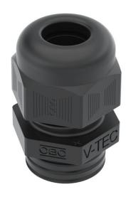
Prensaestopas con rosca de conexión métrica PG de tipo con tuerca de capuchón, para cajas de derivación, carcasa, cajas de distribución en sector privado e industrial. Con descarga de tracción y labio de sellado integrado , probado según DIN EN 62444. Clase de protección IP68. Se puede utilizar entre -20 °C y +65 °C.
