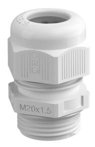
Prensaestopas con rosca de conexión métrica de tipo con tuerca de capuchón, para cajas de derivación, carcasa, armarios de distribución en sector privado e industrial. Con descarga de tracción y labio de sellado integrado , probado según DIN EN 62444. Clase de protección IP68. Se puede utilizar entre -20 °C y +65 °C.
