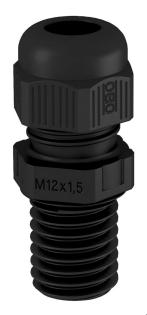
Prensaestopas con rosca de conexión métrica de tipo con tuerca de capuchón, para cajas de derivación, carcasa, armarios de distribución en sector privado e industrial. Con descarga de tracción y labio de sellado integrado, probado según DIN EN 62444. Clase de protección IP68. Se puede utilizar entre -20 °C y
