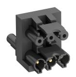
Bloque distribuidor con bloqueo, tipo GST18i, 1 entrada con clavija de enchufe de 3 polos y 3 salidas con conector hembra de 3 polos.
