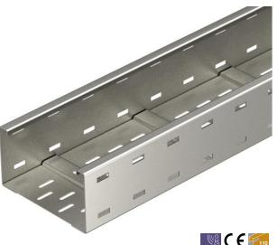
Sistema de bandejas portacables vano ancho, perforado, de ala 110 mm. Las uniones rectas WRVL 110 se piden por separado. Aislamiento magnético sin tapa 20 dB, con tapa 50 dB.
