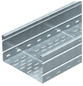
Sistema de bandejas portacables vano ancho, perforado, de ala 160 mm. Las uniones rectas WRV 160 se piden por separado. Aislamiento magnético sin tapa 20 dB, con tapa 50 dB.
