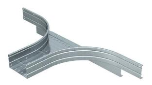
Derivaciones simples para la utilización en horizontal. Para todos los sistemas de bandejas de vanos anchos con la altura del ala de 160 mm. Para aumentar la estabilidad, los accesorios adicionales deben ser previstos para su posterior montaje.
